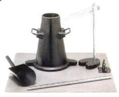
練ったコンクリートのコンシステンシーを測る 最も一般的な試験器具です。
